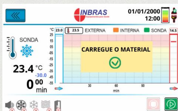
Figura 32 - Aguarda o carregamento da carga
