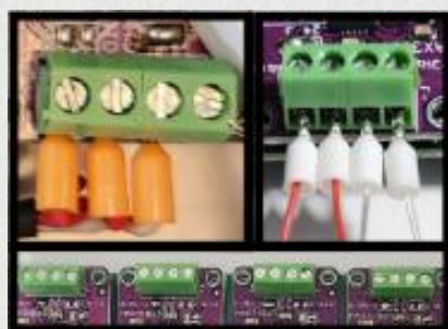
Figura 14 - Ligação dos sensores de temperatura
